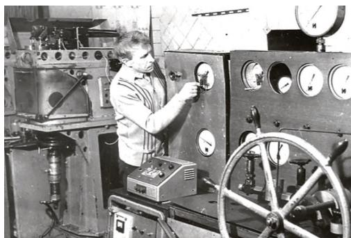
Установки для испытаний на СУ при циклическом сложном напряженном состоянии и комбинированном нагружении изгиб с растяжением
